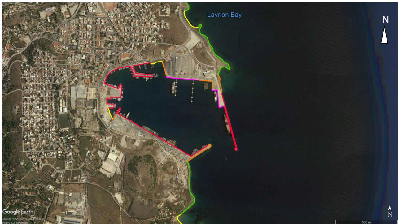
Εικόνα 8-1 Χωρικός προσδιορισμός συντελεστών ανάκλασης των κυματισμών ανάλογα με τον τύπο του στερεού ορίου. Κατακόρυφο μέτωπο συμβατικού κρηπιδότοιχου (κόκκινη γραμμή), κατακόρυφο μέτωπο απορροφητικού κρηπιδότοιχου (μωβ γραμμή), απορροφητική ακτή (κίτρινη γραμμή), βραχώδης ακτή (πράσινη γραμμή), πρανή από φ.ο. (πορτοκαλί γραμμή).
